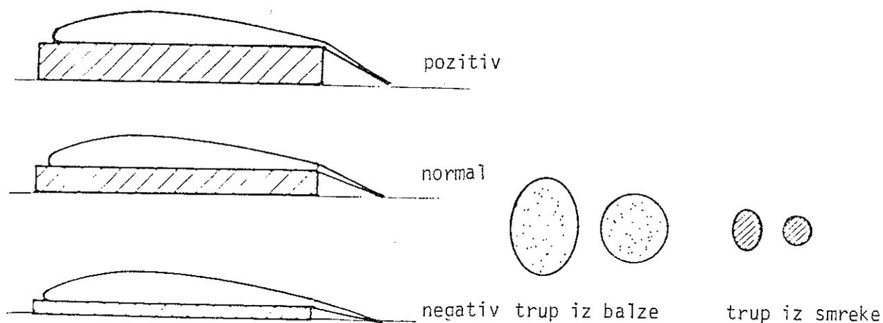
Zadnji del trupa bomo izdelali iz letvice balze ali smreke, ki jo bomo zbrusili do okroglega ali eliptičnega prereza. Takšen trup naj se zoŹuje od glave do repa. Če bo iz balze, ga bomo ojačali pri prehodu glava-trup v dolŹini 15 cm s stekleno tkanino in epoksi smolo. Na model bomo montirali bočno kljukico, na rep pa nalepili trak aluminijeve pločevine za nastavljanje kroŹenja v prostem letu.
